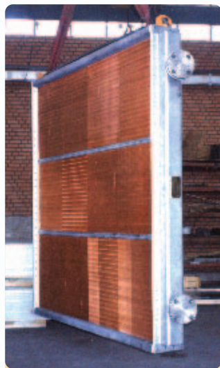
● مبدل‌های خنک‌کننده هوا ژنراتور آبی - کارون ۱ (پروژه زیمنس)
