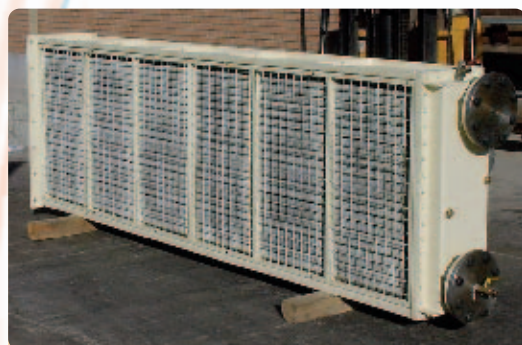
● مبدل‌های خنک‌کننده هوا - ژنراتور گازی (پروژه Ansaldo)
